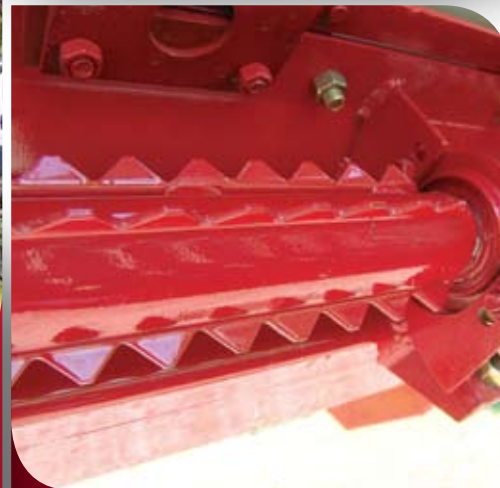
Quitaplantas regulable montado sobre rodamientos
