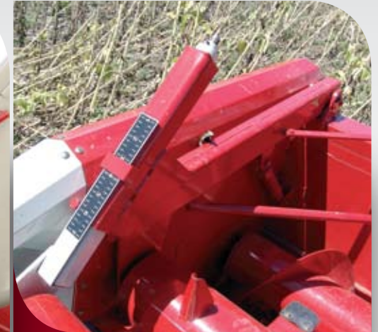
Sistema de Soporte de Rolos de gran robustez y fácil regulación. Opcional hidráulico.
